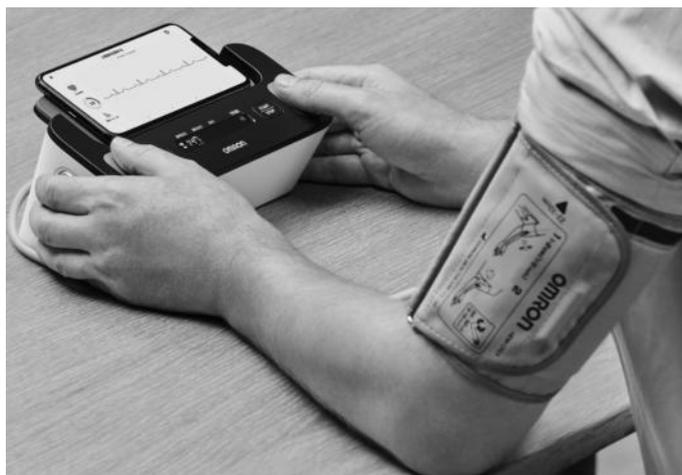
図3 心電計付き血圧計による血圧と心電図の同時記録
