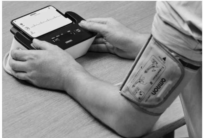
図3 心電計付き血圧計による血圧と心電図の同時記録 〔提供：オムロンヘルスケア(株)〕
