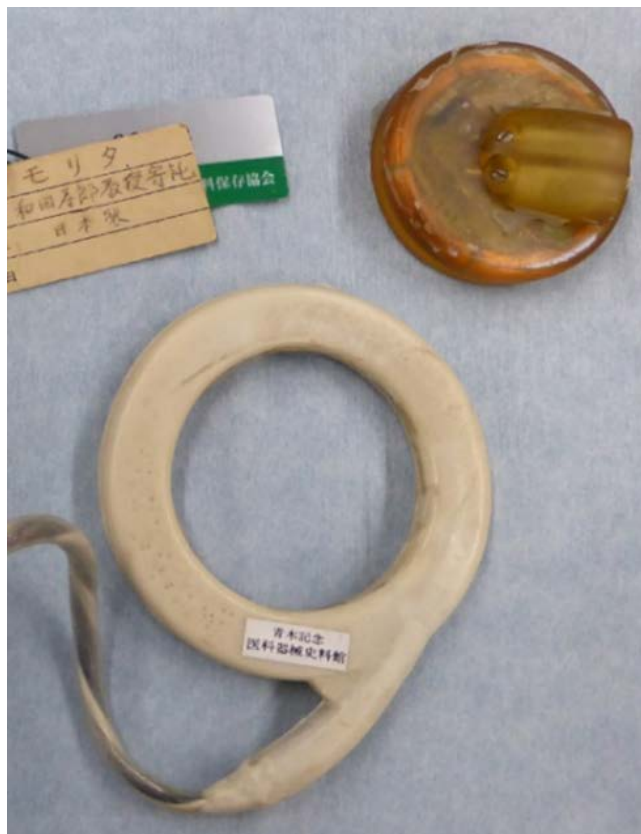
【No.32】 いわしや森田器械店製 —受信機と体表誘導コイルアンテナ (1969年)
