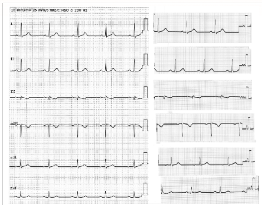
図 7 同じ心電図信号発生器を接続した場合のデジタル心電計の記録例（左）とアナログ心電計の記録例（右）
