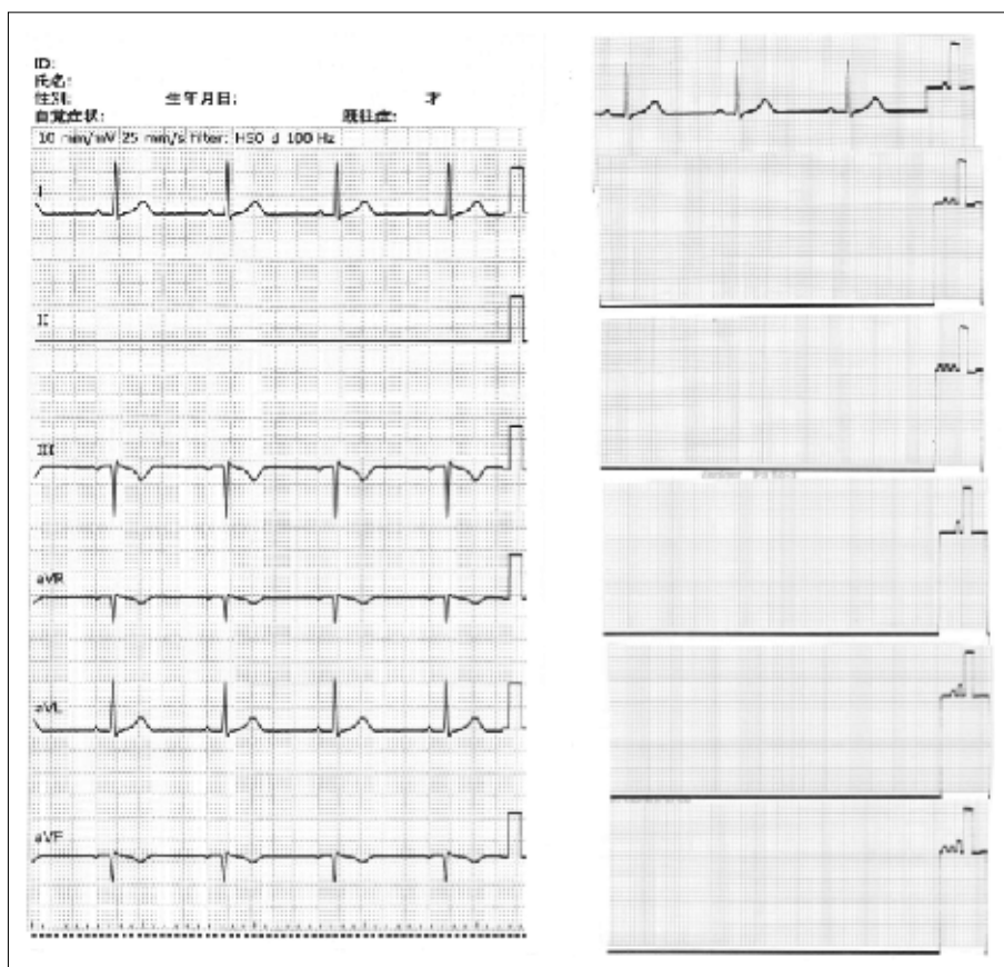
図10 左足の電極が外れた場合のデジタル心電計の記録例（左）とアナログ心電計の記録例（右） 図7と同じ心電図信号発生器を接続して記録したもので、いずれも左足の電極を外している。デジタル心電計の記録の下部にある点線は電極外れマーク。
